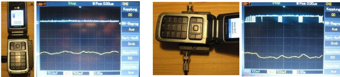
**Bild 21** Die Einstreuung der Sende-Impulse des Handys in das Sensorgehäuse hängt von der gegenseitigen Lage ab
