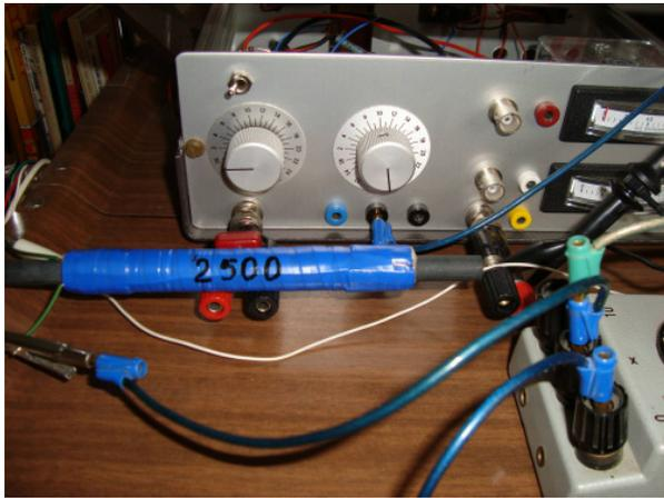
Bild 15 Spule vor dem Sensor
