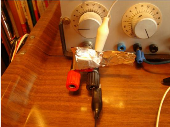
Bild 7 Alu-Folie um den Kondensator
