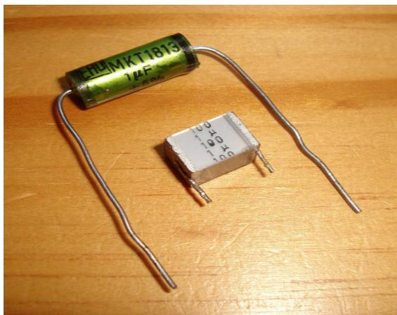
Bild 23 Beispiele für andere Sensor-Kondensatoren
